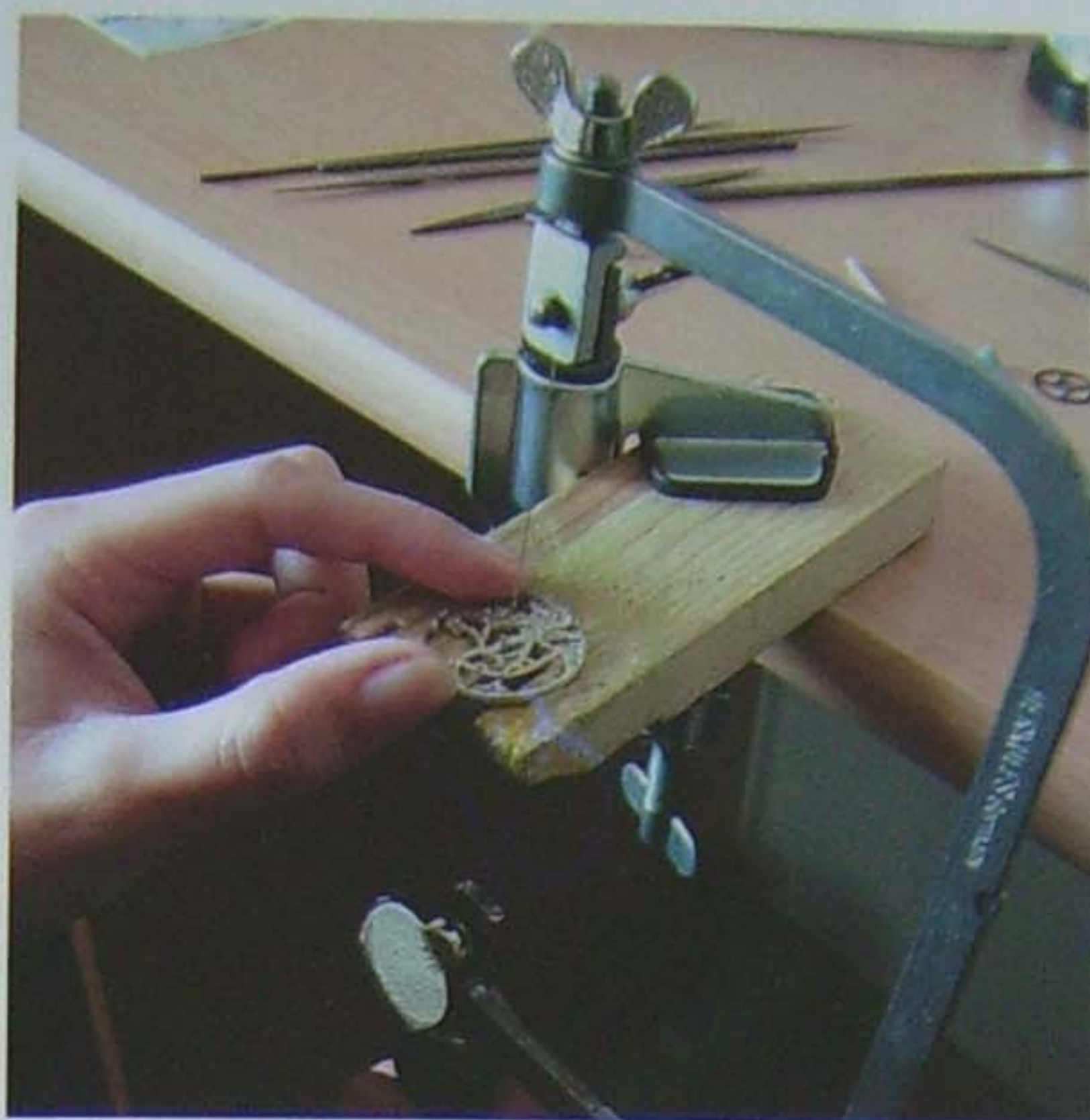
Stefan Kudoke sägt jedes skelettierte Werkteil selbst von Hand aus.
