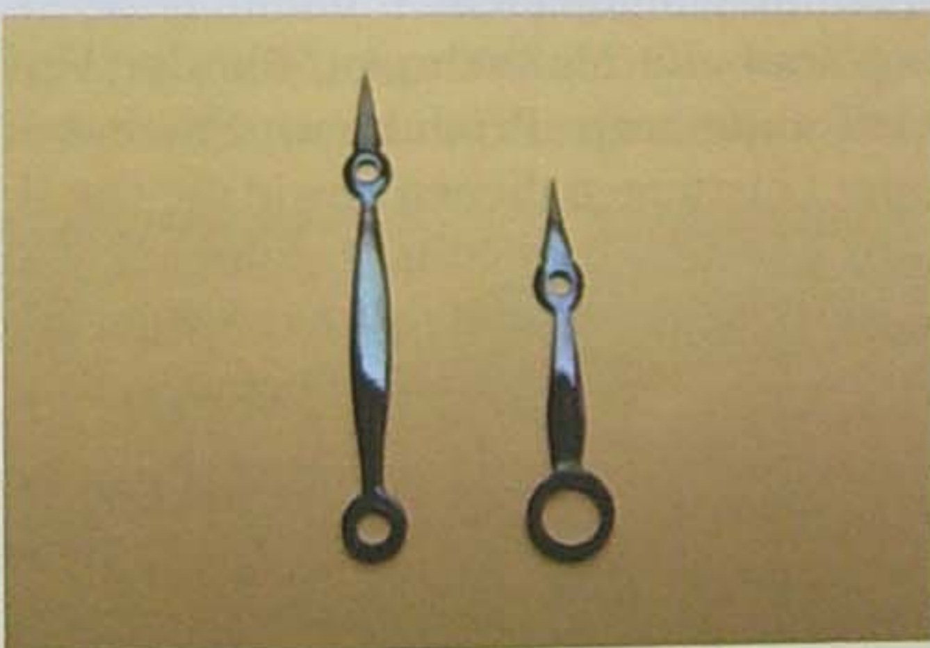
Sogar Zeiger werden von Hand hergestellt und ausgesägt.
